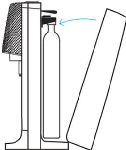
1. Spirit™ソーダメーカーを平らで丈夫な表面に垂直に置きます。背面カバーの上部をつかみ背面カバーを取り外し、ソーダメーカーの本体から引き離します。背面カバーを脇に置きます。
