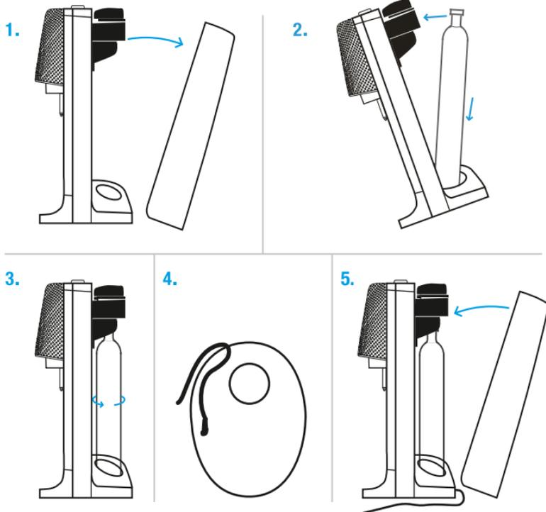
1. SPIRIT ONE TOUCH™ソーダメーカーを平らで丈夫な場所に垂直に置きます。専用ボトルが本体にセットされている場合は必ず外してからガスシリンダーのセット、または交換を行ってください。背面カバーの上部を押しながらソーダメーカーの本体から引き離し、背面カバーを完全に外します。
