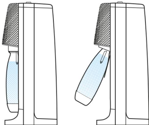
4. お好みの強さの炭酸水ができたら専用ボトルを、完全に前方に傾いた位置になるまで、ゆっくり手前に引きます。これにより専用ボトル内の圧力を開放し、専用ボトルがスナップロックからはずれません。専用ボトルをスナップロックから引き抜かないでください。専用ボトルが自動ではずれるようにしてください。スナップロックから専用ボトルがすぐに外れない場合は、しばらく待ってください。それでも外れない場合は、専用ボトルを垂直位置に戻して、同じプロセスを繰り返してはなりません。そのままお飲みいただくか、または、お好みのSodaStreamシロップを加えて、フレーバー付きの炭酸飲料をお楽しみください！
